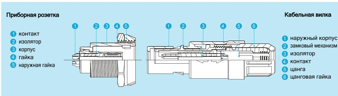
**PKG** Приборная розетка, ключи (G, A..C), угловые контакты (90°) для монтажа на ПП, две крепёжные гайки
